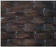
Tissus Tissus uni-directionnels à base de carbone, fibres de verre ou fibres aramides. Principalement utilisés pour les renforcements sismiques ou les renforcements à l'effort tranchant.
